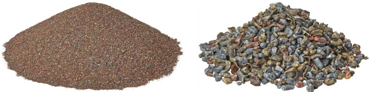
Abbildung 11. Beispielhaft sind hier zwei Produkte der schweren Nichteisenmetalle dargestellt. Dies ist hauptsächlich ein Gemisch aus Kupfer, Zink, Messing. Links ist die Korngrösse 0,5-0,8 mm und rechts die Korngrösse 8-10 mm dargestellt.
