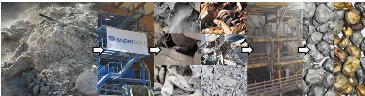
Abbildung 2: Rückgewinnung der Metalle aus der Schlacke. Von links nach rechts: Schlacke nach Müllverbrennung, Ausschnitt der Recyclinganlage, verschiedene Produktfraktionen aus supersort<sup>®</sup>, Ausschnitt aus der Pilotanlage zu supersort<sup>®</sup>metall, hochwertig veredelte Metallprodukte.
