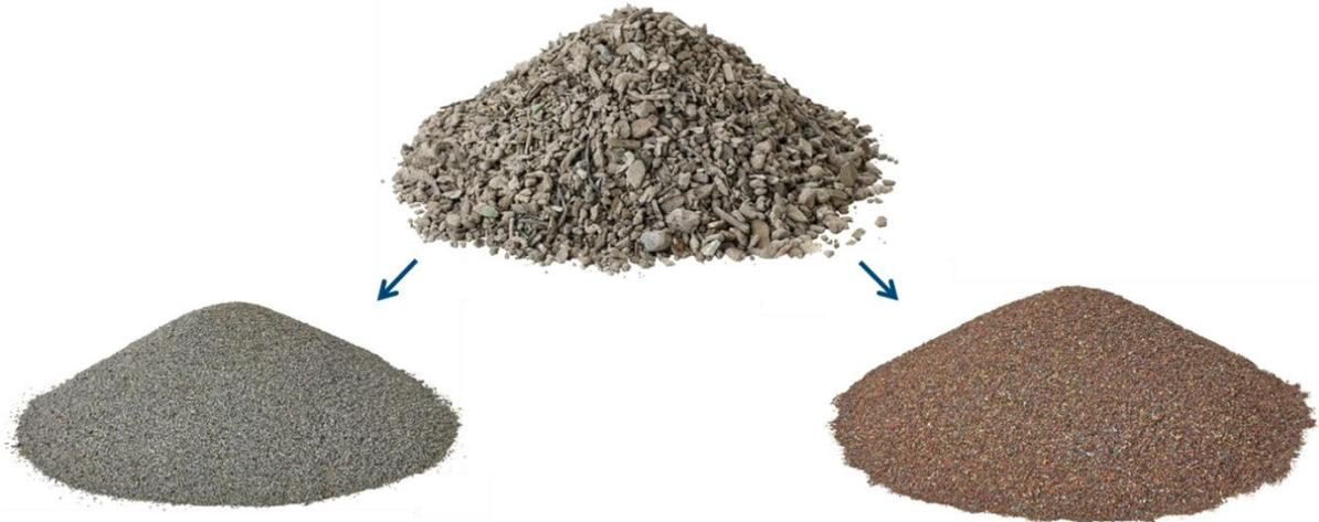
Abbildung 9: Nichteisenmetall-Fraktion (oben) wird befreit von Fremdstoffen und anschliessend sortiert in eine reine Leichtmetall- (links) und eine Schwermetall-Fraktion (rechts)
