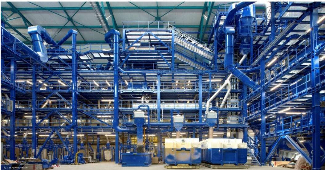
Abbildung 8. Übersicht über Aufbereitungsanlage supersort<sup>@metall</sup> zur trocken-physikalischer Sortierung des NE-Konzentrates in Leicht- und Schwermetallfraktionen
