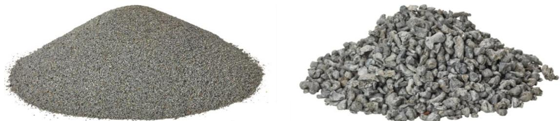
Abbildung 10. Beispielhaft sind zwei Aluminiumprodukte dargestellt. Links ist das Aluminiumprodukt 0,3-0,8 mm und rechts das Produkt 8-12 mm dargestellt.
