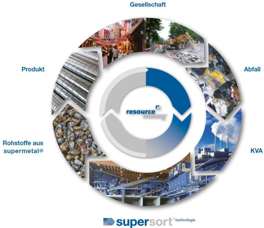
Abbildung 1. Kreislauf des Siedlungsabfalles mit der supersort<sup>®technologie</sup>. Der Abfall wird verbrannt und aus der resultierenden Schlacke die Metalle beinahe vollständig zurückgewonnen. Zudem werden die Metalle so aufbereitet, dass sie direkt in Metallschmelzen Verwendung finden.
