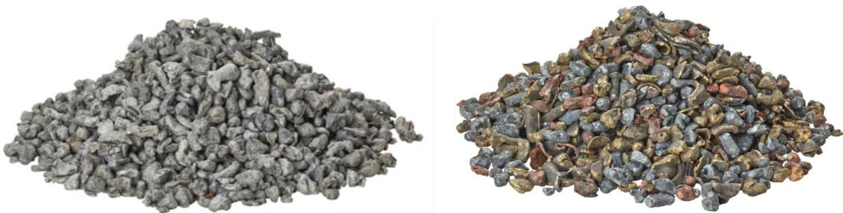
Abbildung 1: Beispielhafte Produkte von Metallen, welche aus nass ausgetragener Schlacke mit Hilfe der supersort®technologie der DHZ AG zurückgewonnen wurden. Links: Aluminium. Rechts: schwere Nichteisenmetalle wie Kupfer, Messing, Zink.
