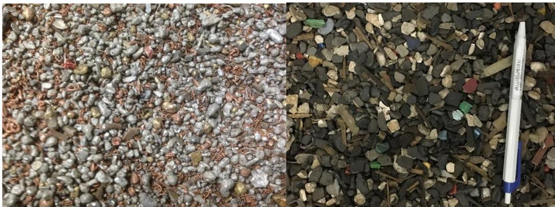
Abbildung 1. Links: Beispiel eines Nichteisenmetallproduktes 1-4 mm. Grau sind Aluminiumpartikel. Rot ist Kupfer hauptsächlich in Form von Drähten und gelb ist Messing. Rechts: Kunststoffprodukt 4-10 mm
