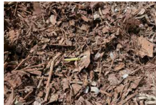
Beispiele dafür, was die «Supersort Technologie» aus der KVA-Schlacke gewinnt, von oben: Alu fein, Schwermetalle-Mix, Nichteisen-Mix 3 bis 12 mm, Eisenschrott grob.
