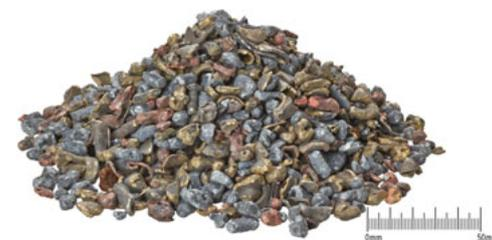
DHZ-Output, Schwerfraktion mit 4 bis 10 Millimeter aus der ersten Aufbereitungslinie.
