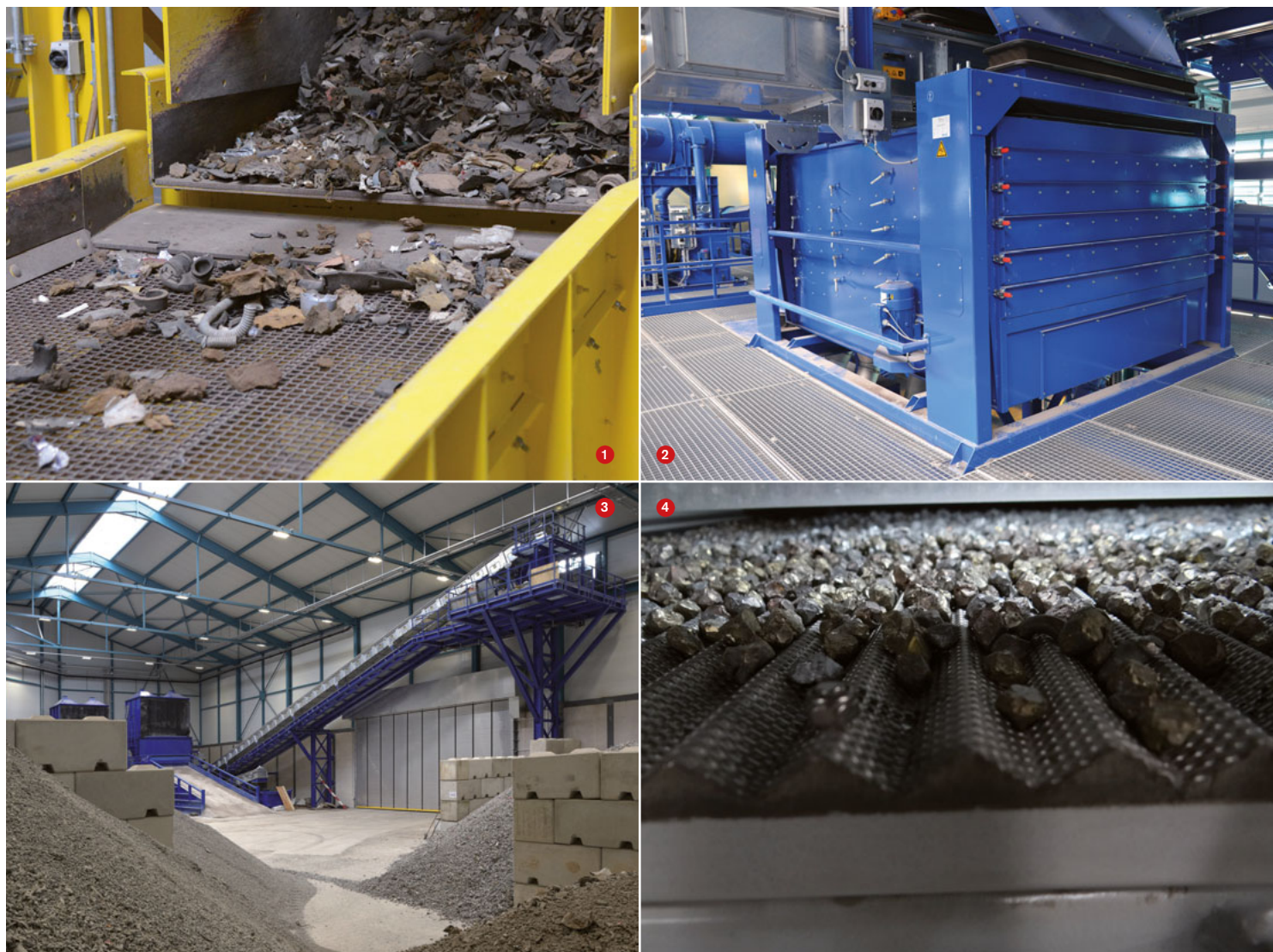
1 Versuchsanlage zur Aussortierung von Kunststoffteilen aus RESH. 2 Siebmaschine für die Korngrössenklassierung. 3 Rohmateriallager und Materialaufgabe. 4 Dichtesortierung, Trennen von leichten und schweren Nichteisenmetallen.
