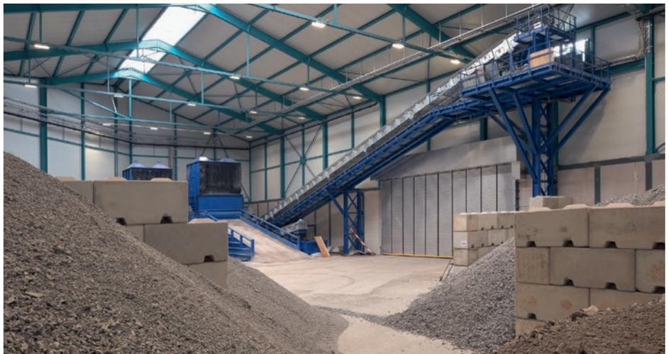
wird anschliessend in ein Aluminium- und ein Schwermetall-Produkt sortiert. Die Aufbereitung dieser Nichteisenmetallgemische erfolgt in der Anlage auf zwei unabhängigen Linien, welche grösstenteils identisch aufgebaut sind. Die erste Linie verarbeitet Gemische im Feinbereich zwischen 0 und 10 mm, während die zweite Linie den gröberen Kornbereich zwischen 10 und 100 mm abdeckt. Der ganze Prozess verläuft tro-
