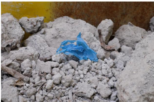
Nicht selten finden sich in Aschen aus Müllverbrennungsanlagen noch Reststoffe wie Kunststoffe, die vor einer weiteren Aufbereitung erst entfernt werden müssen.
