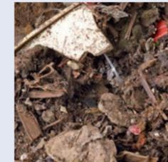
RESH: Schredderrückstände Schredder-Leicht- und Schredder-Schwerfraktionen
